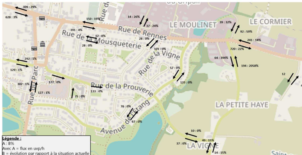
Flux projet à l'HPM – Sans PDU (fond de plan © Contributeurs de OpenStreetMap)
